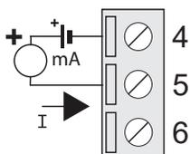
Conexión para utilizar en caso de que la alimentación del loop de corriente provenga desde el exterior.
