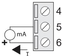
Conexión para utilizar cuando el loop de salida deba ser alimentado directamente por el módulo Z109S-H.
