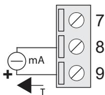
Conexión para utilizar con transductores en tecnología de 2 cables.
