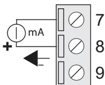
Zu verwendender Anschluss bei Leiter mit Zwei-Draht-Technik.
