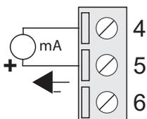
Zu verwendender Anschluss, falls die Speisung des Strom-Loops von außen kommt.
