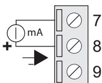
Zu verwendender Anschluss, falls der Eingangsstrom Fremdstrom von außen ist (die Speisung des Loops kommt von außen).
