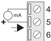
Zu verwendender Anschluss, wenn der Ausgangs-Loop direkt vom Modul Z109S-H gespeist werden muss.
