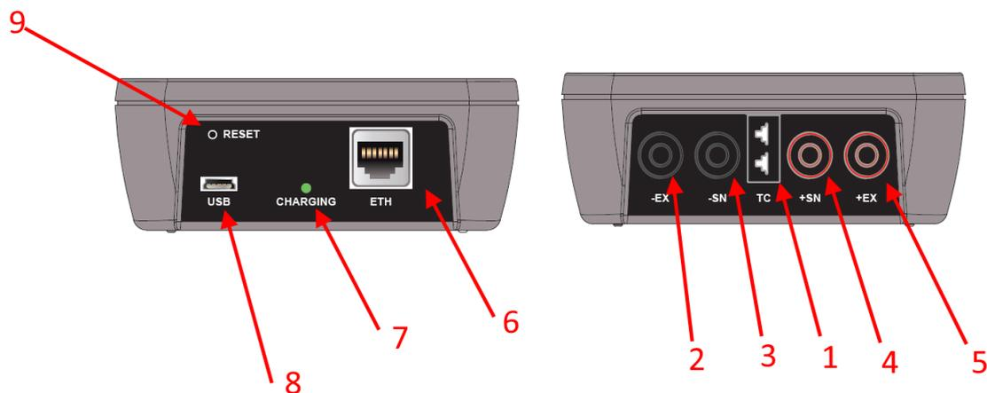
1 Presa per misura/generazione termocoppia
