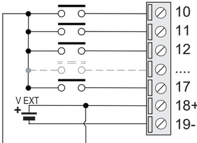
Die digitalen Eingänge müssen extern mit Strom versorgt werden, um ordnungsgemäß zu funktionieren.
