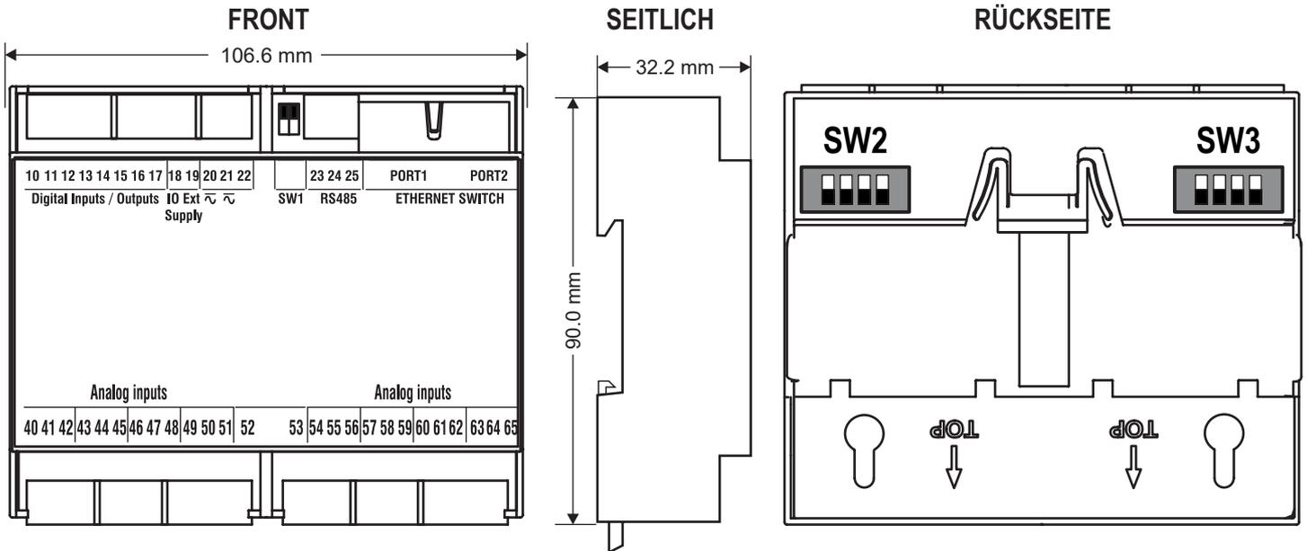
**Gewicht:** 170 g; **Gehäuse:** Material PC/ABS selbstlöschend UL94-V0, schwarz.
