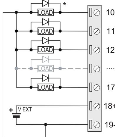
Die Digitalausgänge müssen extern mit Strom versorgt werden, um korrekt zu funktionieren.
