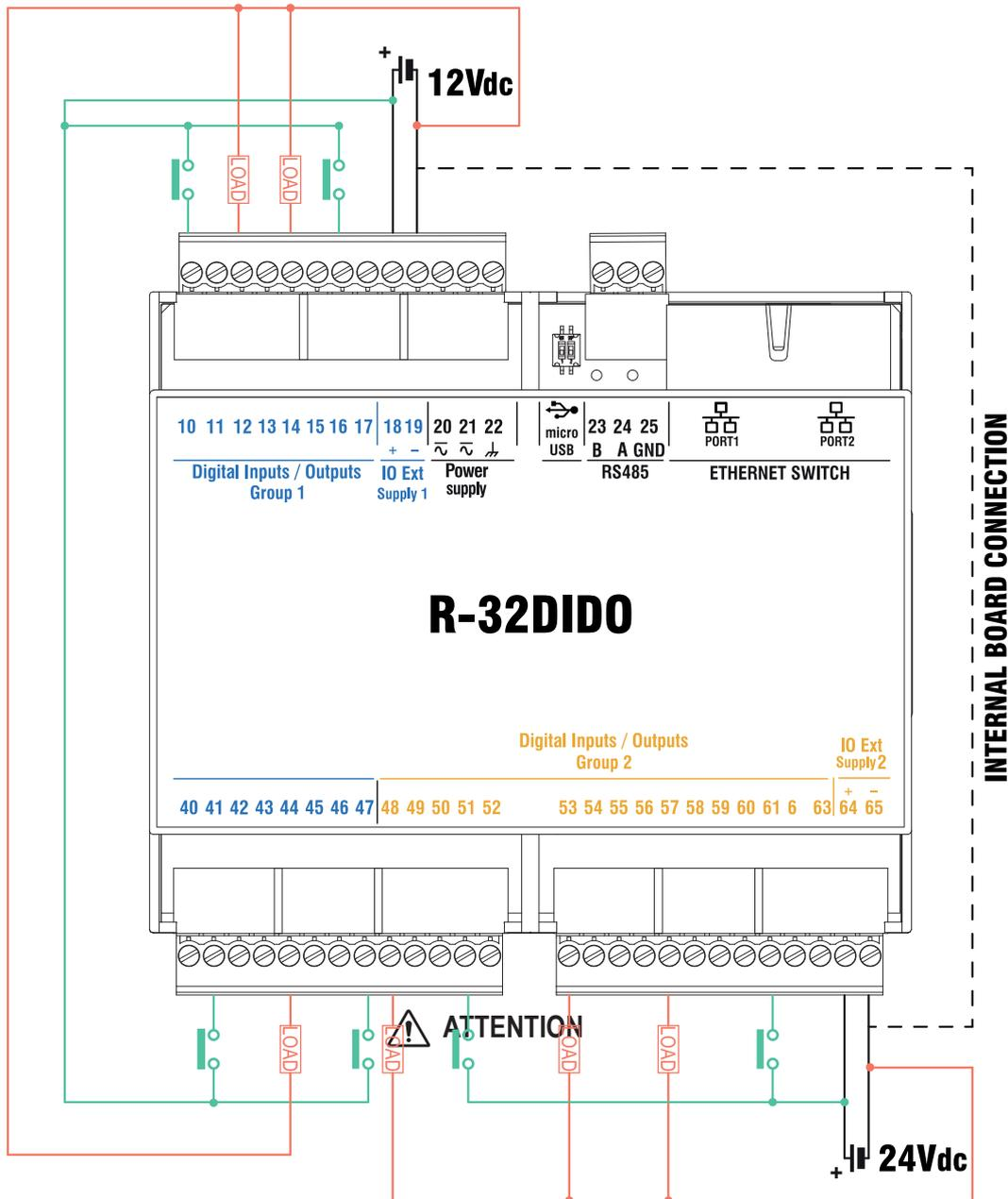
Les alimentations externes IO Ext 1 et IO Ext 2 doivent être alimentées simultanément dans une plage de 12÷24Vdc.
