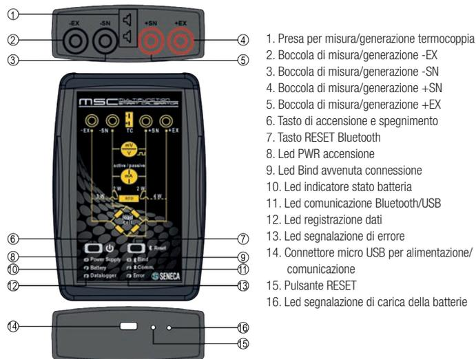
1. Presa per misura/generazione termocoppia
