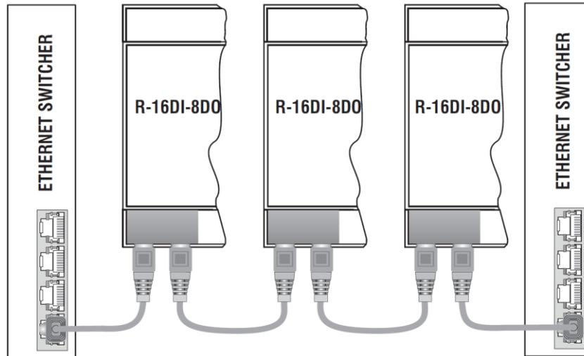
Nei cablaggi ethernet non deve essere presente alcun loop, pena il non funzionamento della comunicazione, alcuni esempi di cablaggi errati sono i seguenti:
