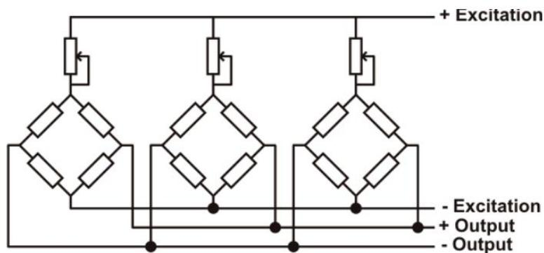
Un resistore variabile, indipendente dalla temperatura, o un potenziometro tipicamente da 20  $\Omega$  è inserito nel cavetto + excitation di ciascuna cella di carico. Ci sono due modalità per trimmerare le celle di carico. Il primo metodo è di regolare i potenziometri per tentativi spostando i pesi di calibrazione da un angolo ad un altro.
