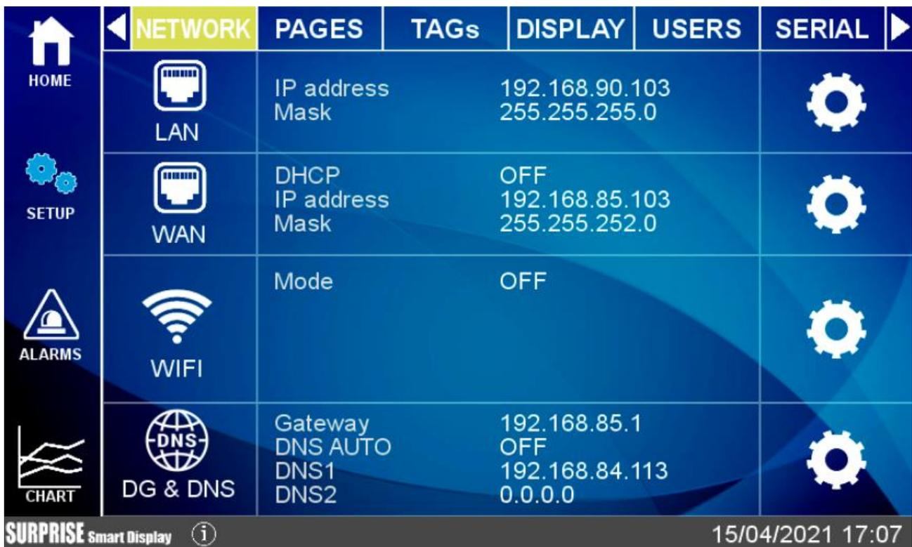
In questa sezione è possibile configurare le impostazioni delle due ethernet LAN e WAN e della porta WI-FI. Nella sezione della porta WI-FI è possibile anche selezionare la modalità WI-FI Station o Access Point. Nella modalità Station è il dispositivo che è connesso ad un access point Wi-Fi esistente, nella modalità Access Point il dispositivo Seneca creerà una nuova rete Wi-Fi a cui potranno collegarsi altri dispositivi.
