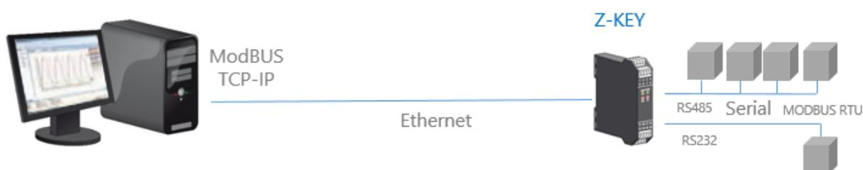
È possibile anche una comunicazione remota attraverso internet con più Client Modbus TCP-IP:
