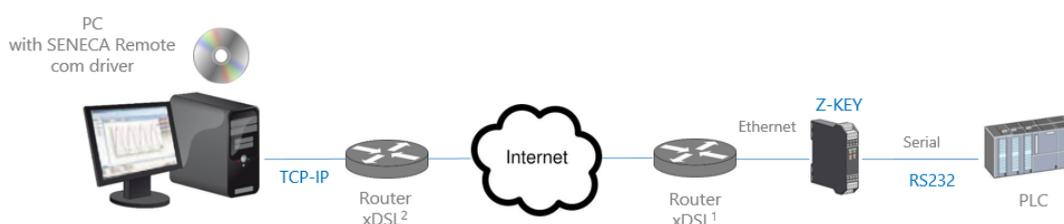
Per la comunicazione via internet il Router collegato al gateway deve avere un indirizzo ip statico.
