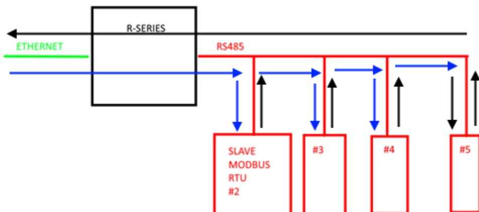
Ogni richiesta Modbus TCP-IP con station address diverso da quello del dispositivo della serie R viene convertito in pacchetto seriale sulla RS485 e, nel caso di risposta, viene rigirato su TCP-IP.
