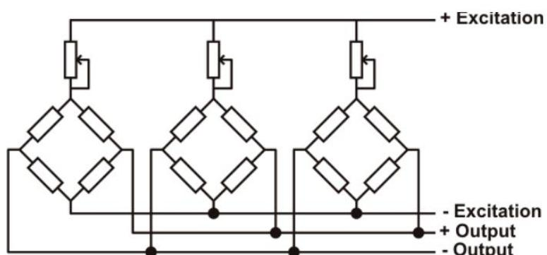
Un resistore variabile, indipendente dalla temperatura, o un potenziometro tipicamente da  $20\ \Omega$  è inserito nel cavo + excitation di ciascuna cella di carico. Ci sono due modalità per trimmare le celle di carico. Il primo metodo è di regolare i potenziometri per tentativi spostando i pesi di calibrazione da un angolo ad un altro. Tutti
