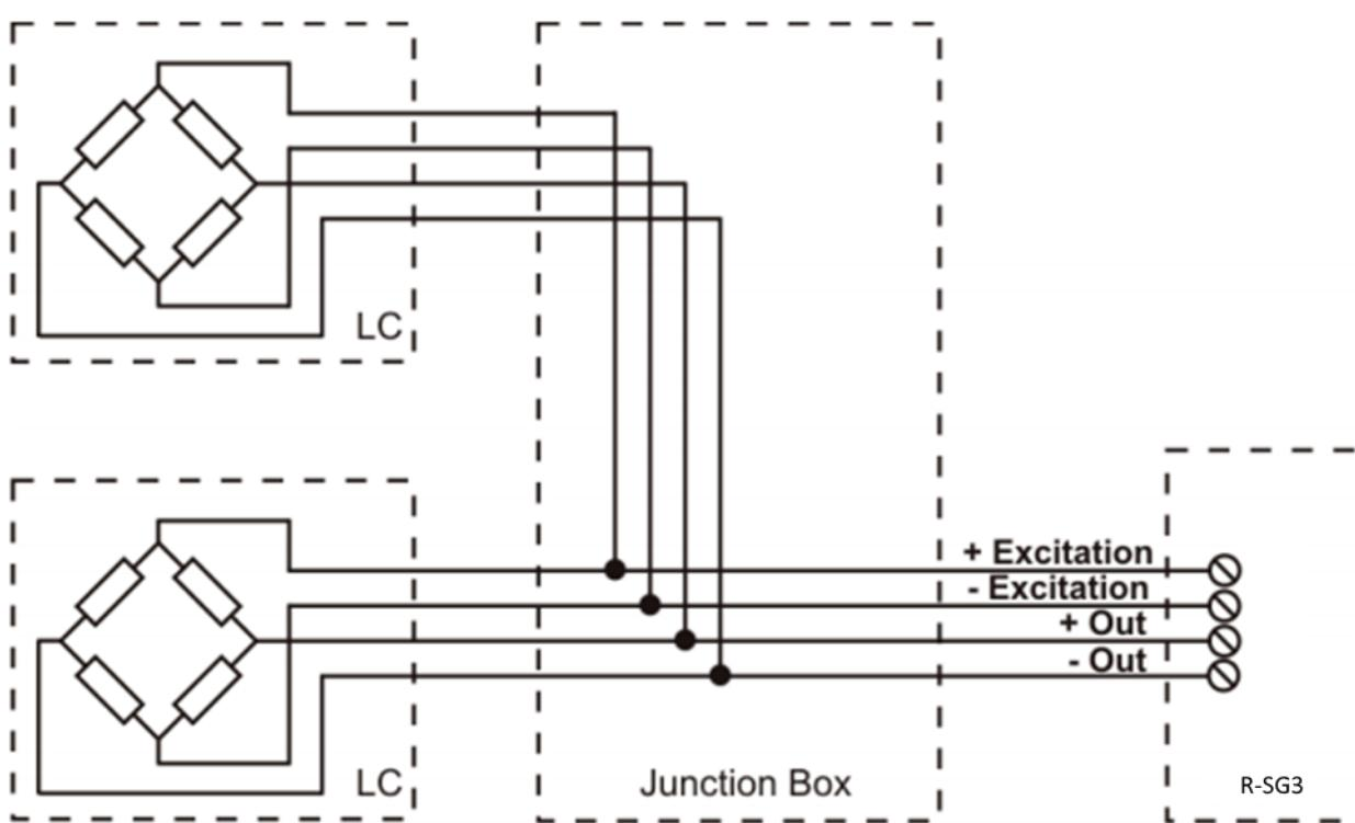
Per collegare in parallelo 2 o più celle a 6 fili con la Junction Box SG-EQ4 utilizzare il seguente schema:
