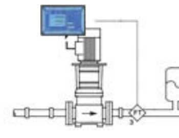
Pumpenregelungsschema basierend auf Durchflussmessung
