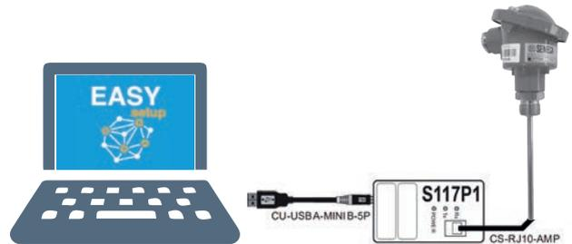
La configurazione dei trasmettitori T120 e T121 montati sulla testa della PT100 può avvenire tramite S117P1, convertitore USB - RS232/TTL e software EASY SETUP. Il modulo può essere configurato anche se non alimentato dal loop 4..20 mA, traendo alimentazione tramite il connettore di programmazione.
