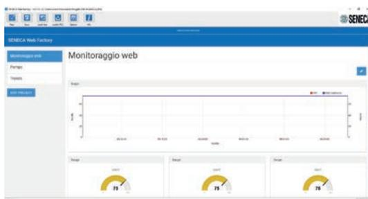
Web Factory è un tool licensefree, intuitivo e dotato di interfaccia responsiva che permette di sviluppare pagine web a partire dai progetti ZNET4 e di caricarle nelle CPU SENECA. Queste pagine possono contenere valori numerici, campi di testo, indicatori visivi di tipo LED o gauge e grafici real-time. Tali pagine permettono l'interazione con le variabili dichiarate nel progetto Z-NET4 per mezzo di pulsanti grafici.
