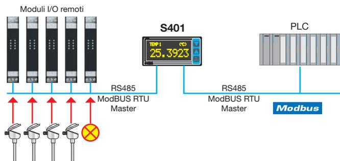
ACQUISIZIONE E TRASMISSIONE TEMPERATURE A SISTEMA DI CONTROLLO IN CATENA CHIUSA
