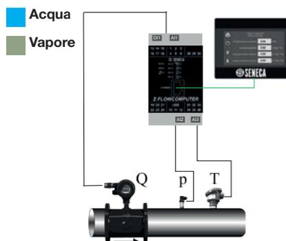
Questa applicazione ha come scopo la misura della quantità di calore e della massa di fluido che scorre nella tubazione. Per la misura su vapore surriscaldato sono necessari: misura di portata, misura di temperatura e di pressione. Per la misura su vapore saturo sono sufficienti le misure di portata e di pressione o di temperatura (solamente una delle due). Per la misura su acqua sono necessari solamente la portata e la temperatura.
