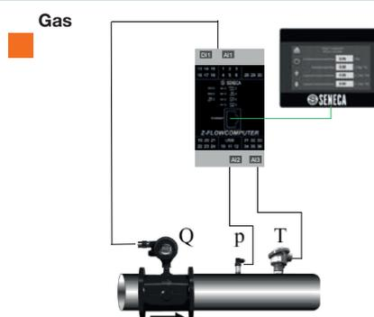
Questa applicazione ha come scopo la compensazione della portata e la correzione del volume di un gas con riferimento alle condizioni di base di temperatura (Tb) e pressione (Pb), a partire dalla misura alle condizioni di lavoro Q, P e T. Per effettuare le compensazioni si utilizzano gli algoritmi di calcolo normati richiamati nella tabella sottostante.
