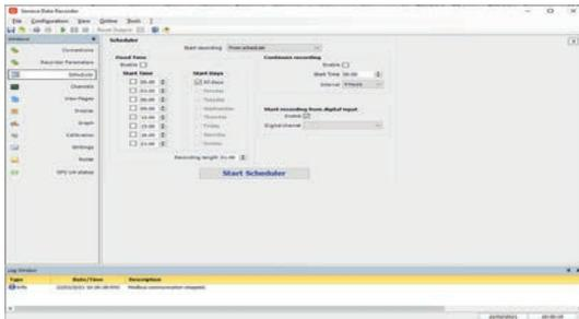
Una schedulazione flessibile permette la registrazione in modalità manuale o la registrazione automatica fino a 8 orari prefissati, in continua e con avvio da ingresso digitale.
