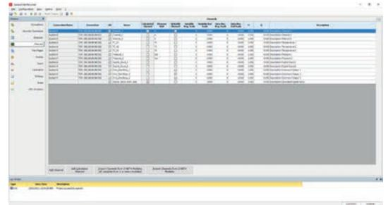
La pagina Canali permette di importare o impostare i singoli. È possibile abilitare/disabilitare il salvataggio su database, selezionare l'unità di misura da assegnare al canale oltre a fissare inizio/fine di registrazione e descrizione.
