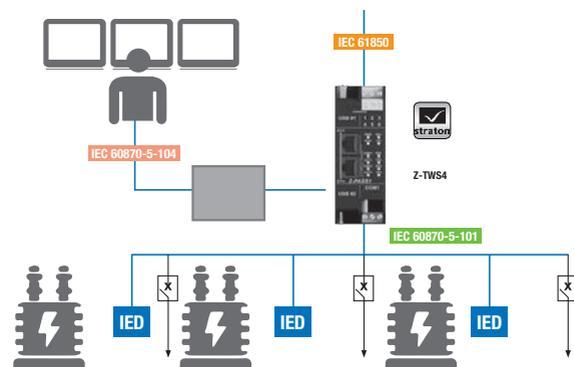
I controllori SENECA per applicazioni di Energy Management possono fungere da IEC 61850 Server, da sistema di conversione ModBUS-RTU - ModBUS TCP, da apparati di creazione di reti virtuali via internet e di tunnel punto-punto.
