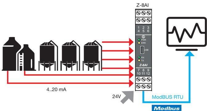
ACQUISIZIONE E VISUALIZZAZIONE MODBUS PER SISTEMI DI PESATURA
