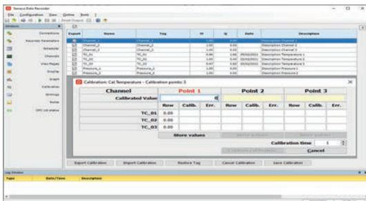
È possibile la calibrazione di uno o gruppi di canali (misure da TC e/o PT-100) utilizzando una interpolazione lineare calcolata su un numero variabile da uno cinque di punti a scelta dell'utente.
