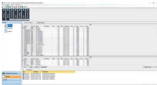
Z-NET4 permette di dichiarare le variabili I/O in campo, le variabili ModBUS e le variabili PLC per poi utilizzarle negli applicativi integrati (Web Factory, Trend Viewer), esportarle nell'ambiente Straton o tramite tecnologia OPC. In Z-NET4 viene effettuata l'impostazione dei parametri di acquisizione e registrazione dati per l'applicazione DAQ ModBUS integrata "Data Recorder".
