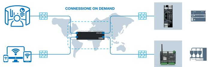
La modalità Teleassistenza Point-To-Point (comunicazione on demand) stabilisce una connessione punto-punto tra supervisione e macchina. Ideale per applicazioni di manutenzione e diagnostica remota.
