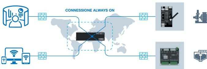
In modalità Telecontrollo Single LAN (connessione always on) viene assegnato un IP statico e pubblico al server VPN BOX. La comunicazione risulta simultanea e sempre attiva tra tutti i siti remoti e le diverse sottoreti che fanno parte del sistema complessivo.
