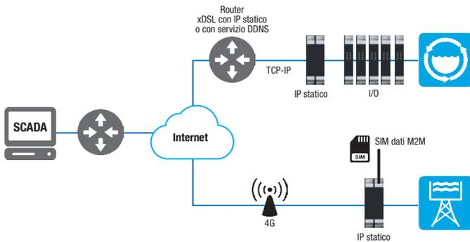
Il telecontrollo via Internet offre servizi di visualizzazione remota, notifica allarmi, gestione remota impianti, supervisione raccolta e analisi dati, sfruttando Internet, lo standard 4G e la tecnologia DDNS.
