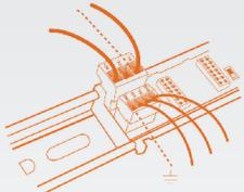
Alimentazione e trasmissione dei dati sono garantiti da supporto bus (RS485) componibile da guida DIN in formato 1, 2, 4, 8 slot. In alternativa, a seconda dei modelli, l'alimentazione e la trasmissione dati sono distribuite tramite morsetti o connettore IDC10..
