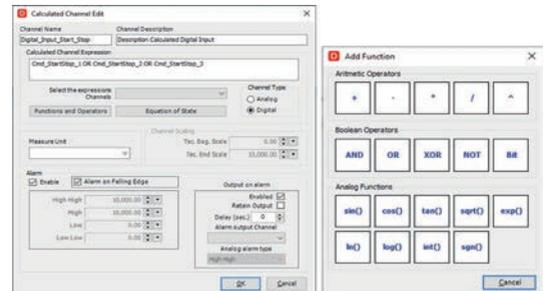
Oltre ai canali fisici il software permette la creazione di canali calcolati a partire da combinazioni dei canali importati e operatori matematici, dà la possibilità di inserire una eventuale scalatura diversa per ogni canale
