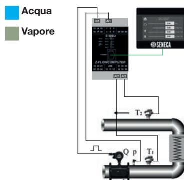
Questa applicazione ha come scopo la misura della potenza e dell'energia scambiata con un altro sistema. Z-FLOWCOMPUTER calcola la potenza in transito nella tubazione di mandata e nella tubazione di ritorno e ne esegue la differenza; il risultato è la potenza termica scambiata.
