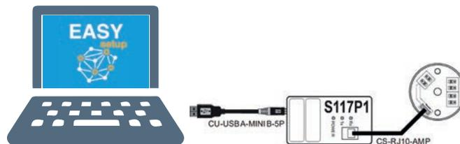
La configurazione dei trasmettitori T120 e T121 può avvenire tramite lo strumento EASY USB, che converte il segnale seriale dall'USB del PC in un segnale seriale UART TTL e viceversa, e software EASY LP. Il modulo può essere configurato anche se non alimentato dal loop 4...20 mA, traendo alimentazione tramite il connettore di programmazione.
