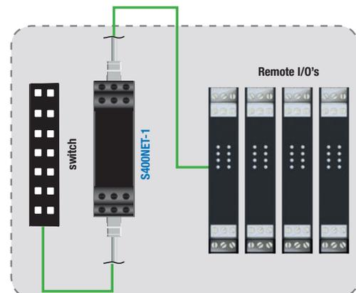
Collegamento Ethernet con lo switch posizionato nel Quadro Elettrico in locale
