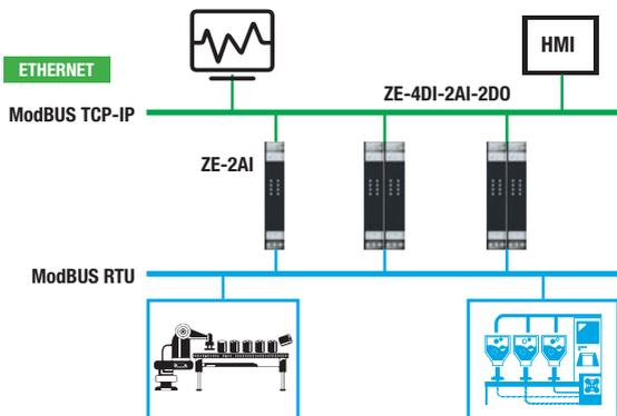
CONNESSIONE ETHERNET DAISY CHAIN E MODBUS PASS-THROUGH
