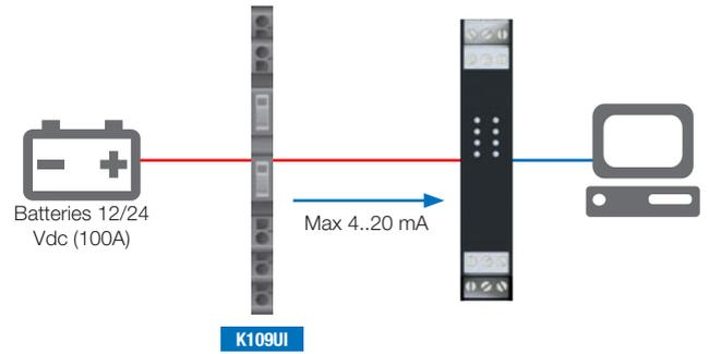
CONVERSIONE, ISOLAMENTO E RITRASMISSIONE SEGNALE ANALOGICO DA SENSORE IN TECNICA 2 FILI
