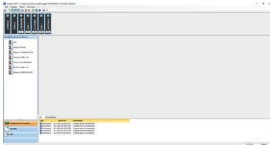
Un progetto di automazione ZNET4/Straton si basa su file di configurazione generati da ZNET4 che includono: le variabili relative ai moduli I/O, le variabili PLC definite, dall'utente, i task ModBUS RTU Master per la lettura/scrittura variabili di I/O, la definizione delle variabili PLC accessibili tramite ModBUS TCP Server e/o ModBUS RTU Slave.
