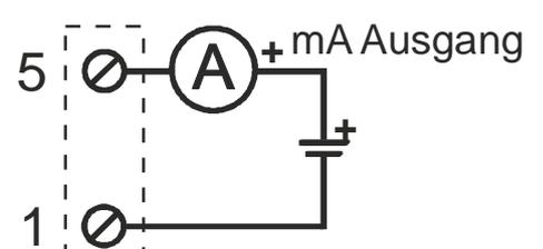
(8) Bereits gespeister, aktiver Ausgang zum Anschluss an passive Eingänge.
