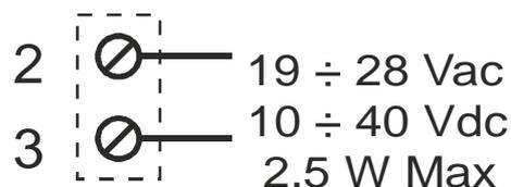
Die Versorgungsspannung muss zwischen 10 und 40 Vcc (unabhängig von der Polarität), 19 und 28 Vca;
