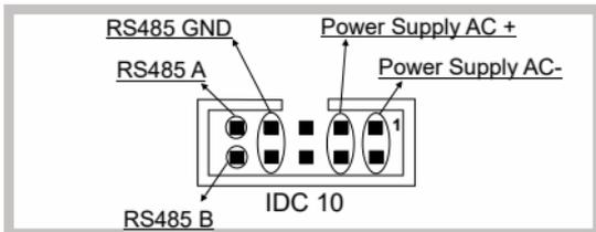
Auf der Abbildung wird die Bedeutung der verschiedenen Kontaktstifte der Steckverbindung IDC10 angegeben, falls die Signal direkt abgegriffen werden sollen.
