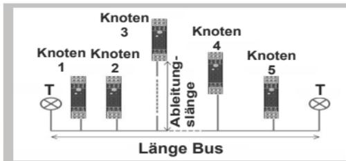
Für die Erzielung der max. Leistungen empfehlen wir die Verwendung von abgeschirmten Spezialkabeln wie zum Beispiel BELDEN 9841.
