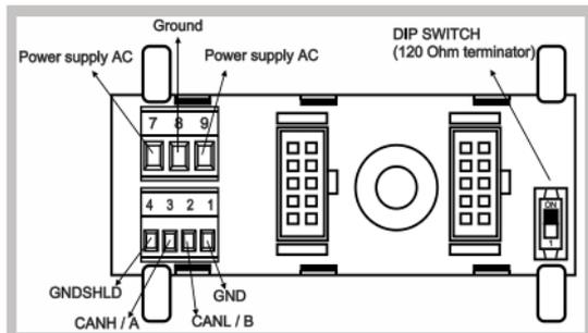
Bei Verwendung des Zubehörteils Z-PC-DINAL2-17,5 können die Signale an der Klemmleiste abgegriffen werden.
